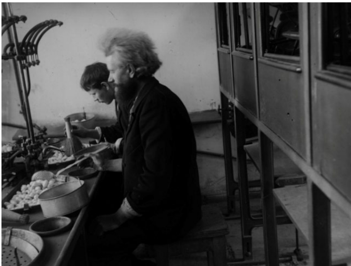
SP7145. Dévidage de la soie sur les métiers à vapeur italiens de la Station séricicole du Caucase. Tbilissi, Géorgie. 1893. Photo de Konstantin Zanis.
